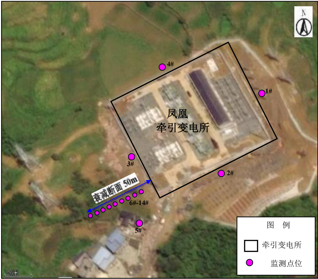
图 10.4-1 类比凤凰牵引变电所电磁环境监测布置图
