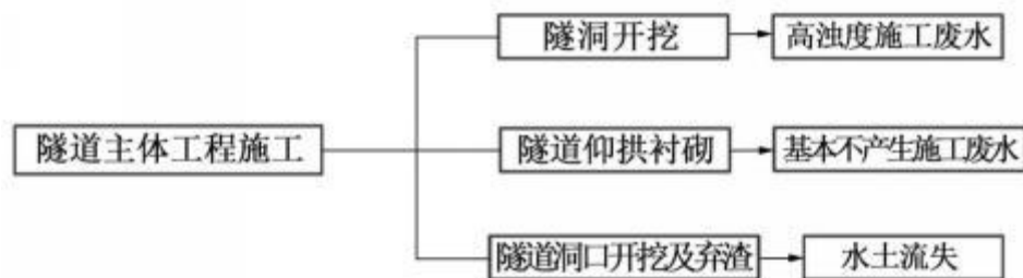
图7.5-3 隧道主体工程施工废水产生环节图
