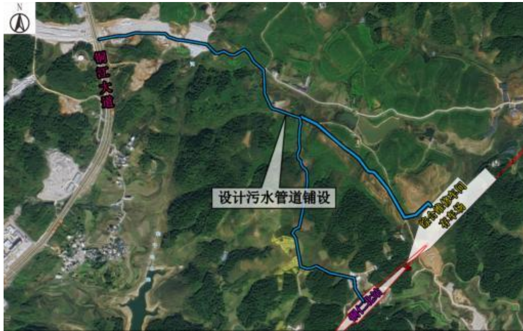
图 7.3-3 铜仁北站设计污水接管示意图
