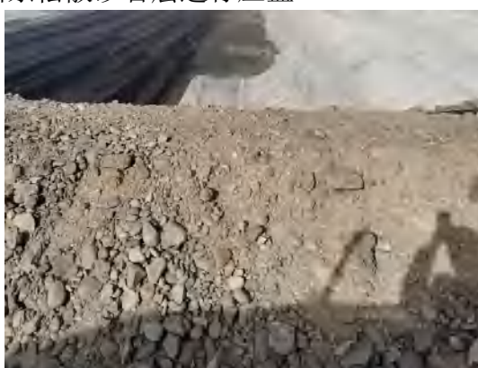
排土场平台压盖第四系松散砂砾层
