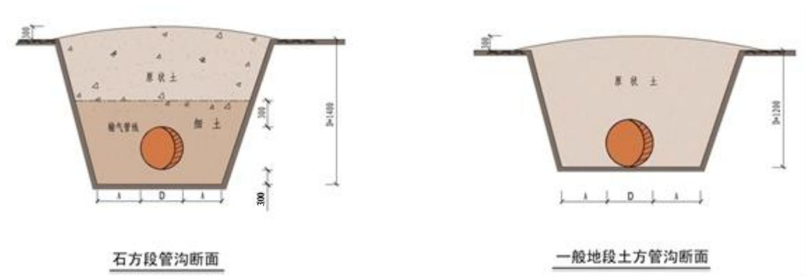
图 2.6-1 不同地段管沟断面示意
