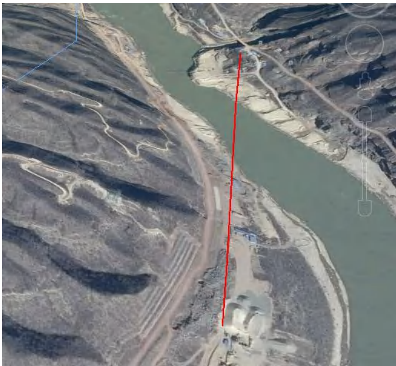
图 8.2-3 黄河定向钻穿越断面示意图
