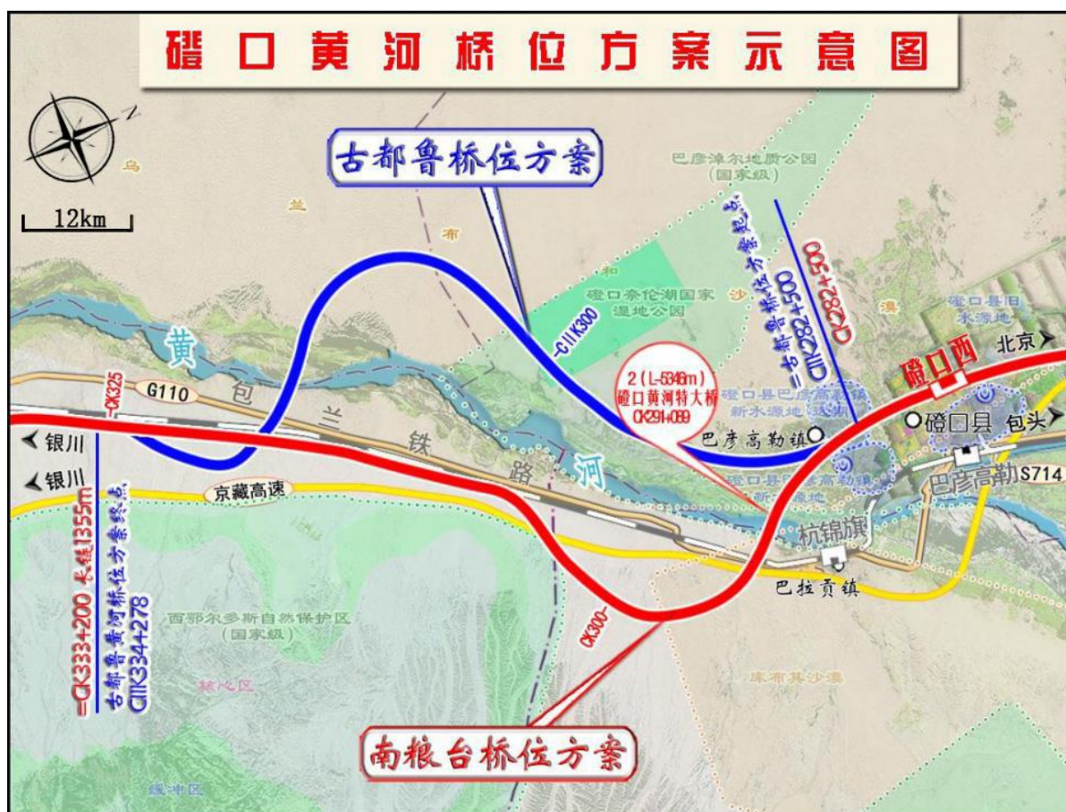
图 4.4-10 磴口黄河大桥通道方案比选示意图
