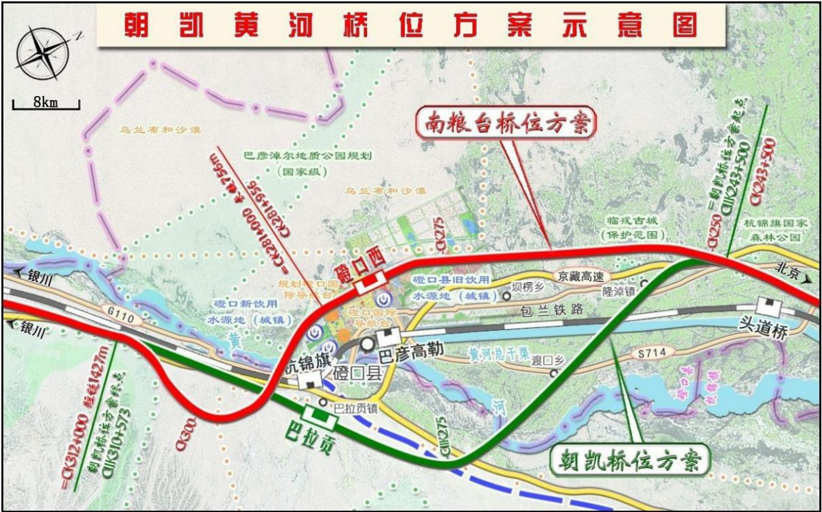
图 4.4-11 磴口黄河大桥通道方案比选示意图
