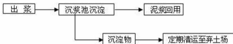
图 2.3-3 泥浆处理流程图
