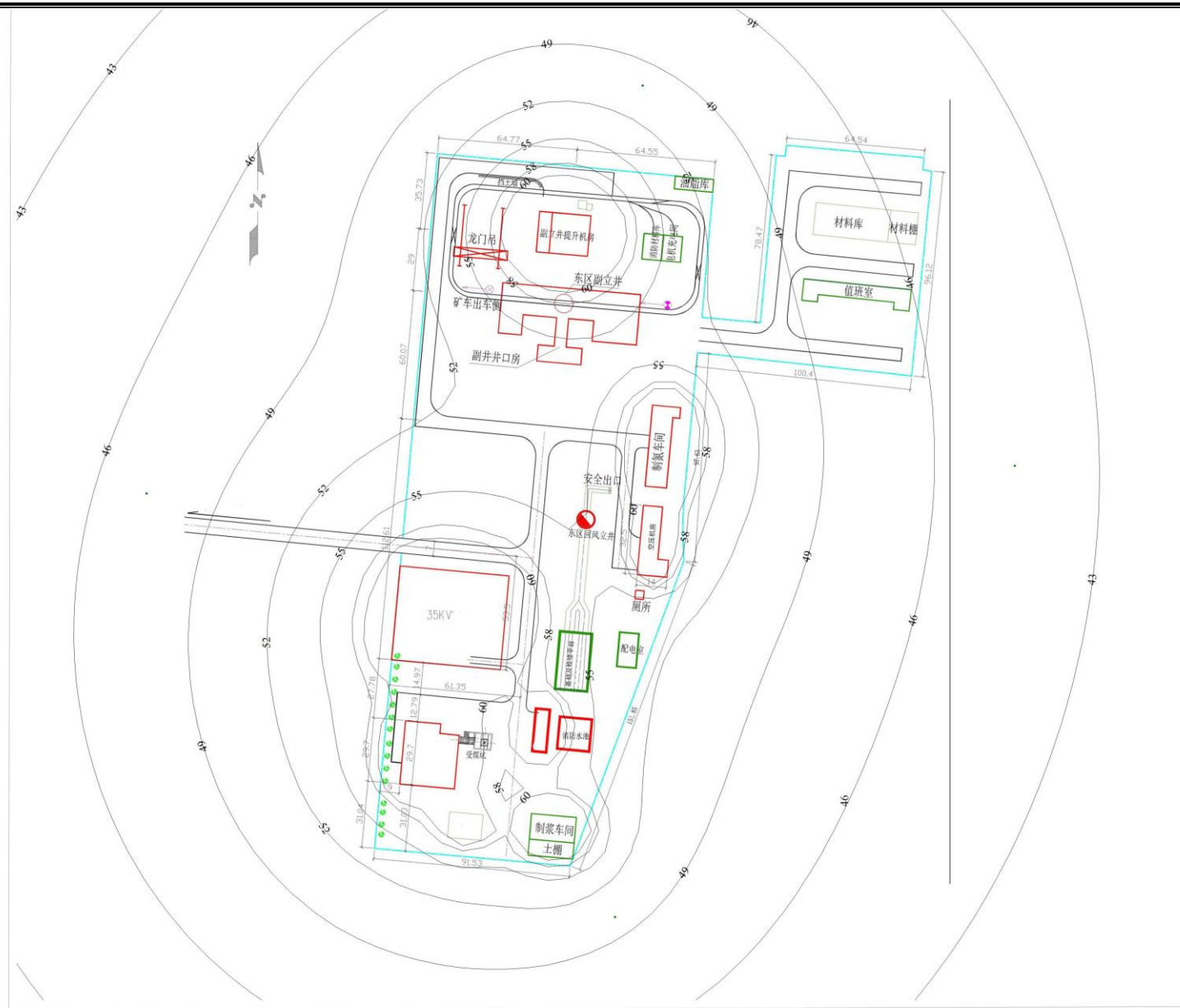
图10.3-2 东区工业场地噪声预测贡献值等值线图
