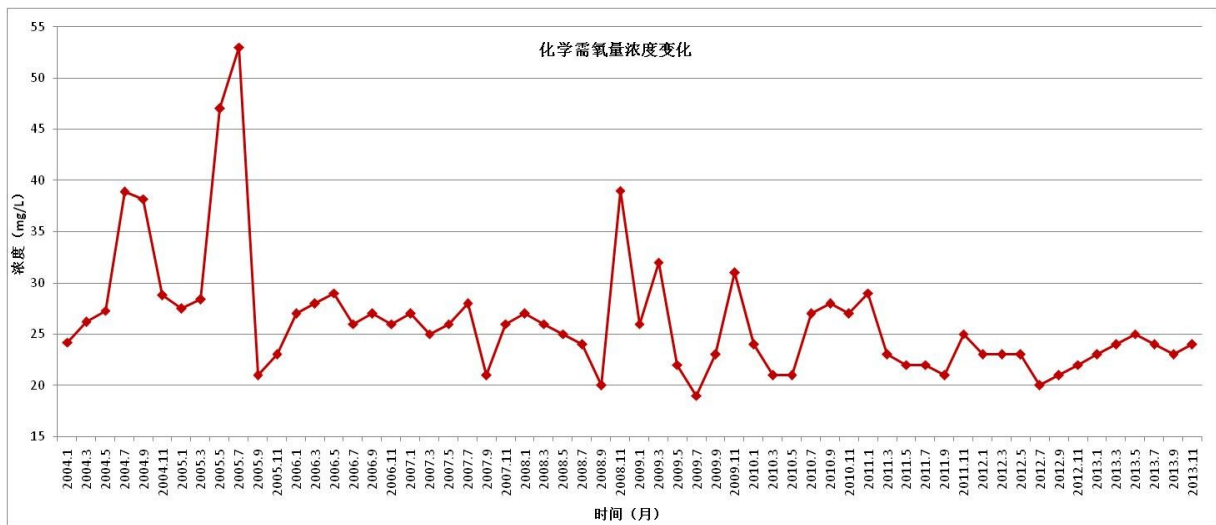
图 3.2.2-2 扬湾腰闸断面 2004~2013 年 COD 浓度变化图
