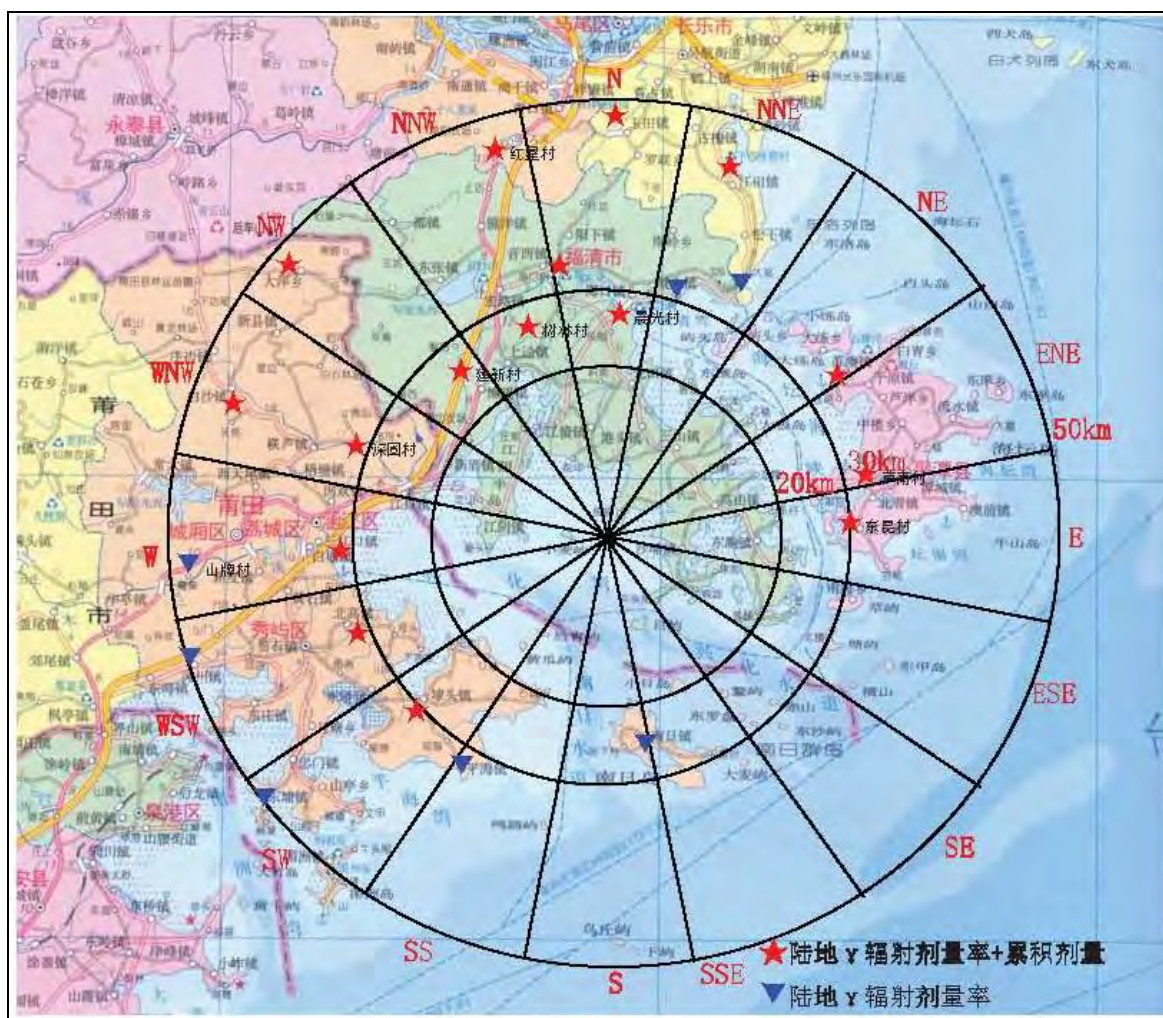
图 3.1-2 50km 范围内原野贯穿辐射剂量率、累积剂量测量点布点示意图
