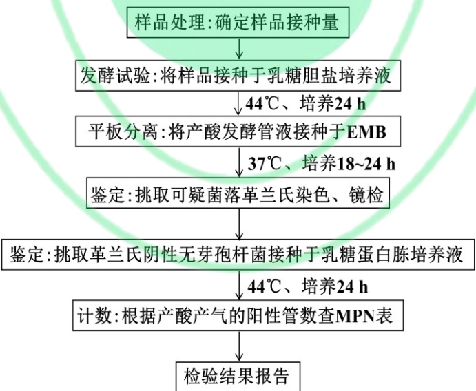
图 A.1 污泥中粪大肠菌群检验程序
