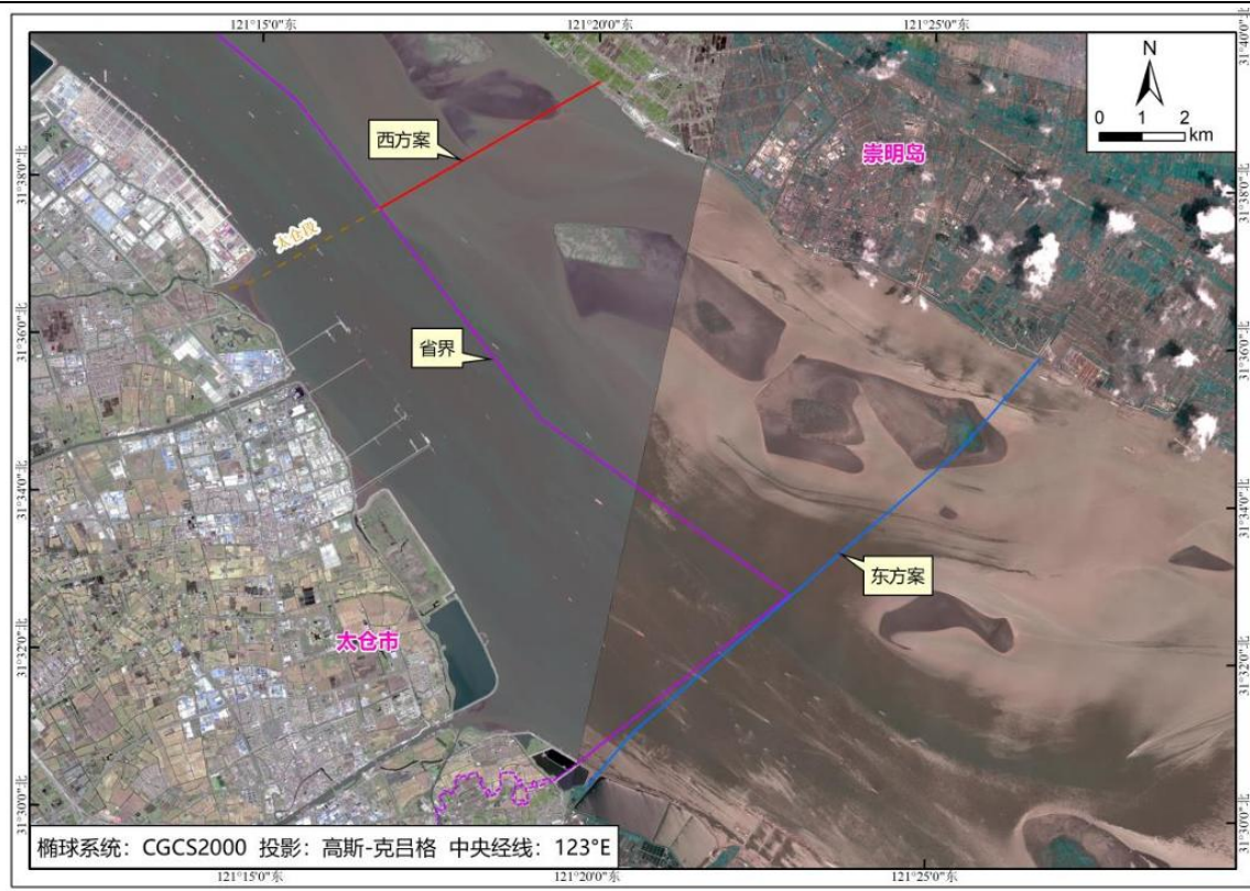
图 3.5-4 过江隧道路由方案示意图
