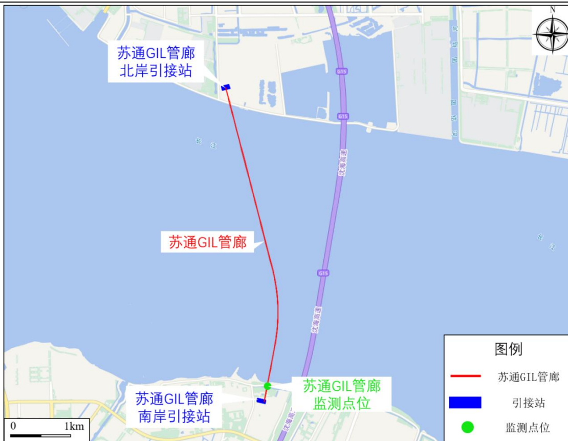
图 6.1-5 类比 1000kV GIL 管廊监测点位示意图
