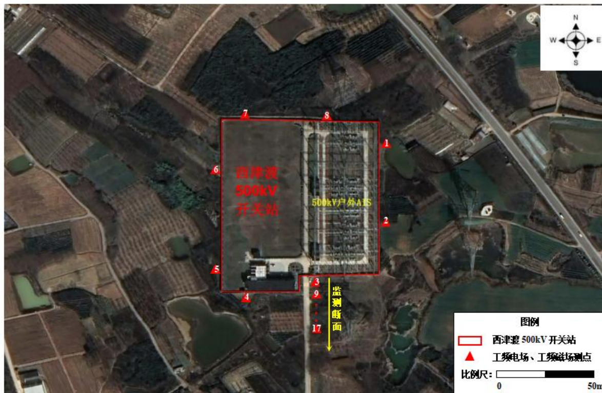
图 6.1-1 西津渡 500kV 开关站监测布点图
