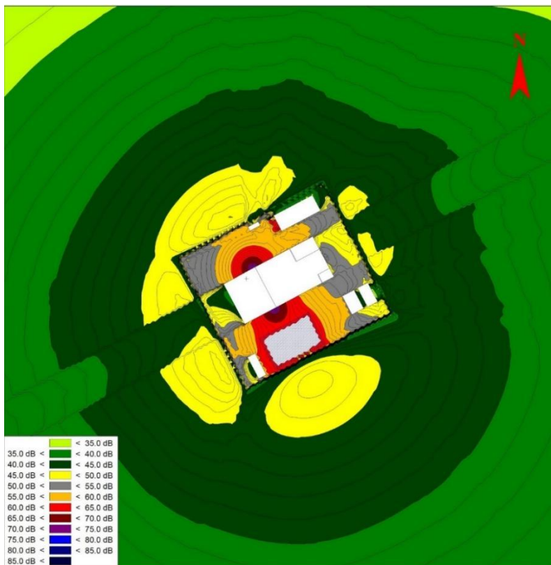
图 6.2-5(d) 太仓接收站噪声贡献值等声级曲线预测图 (1.2m 高)
