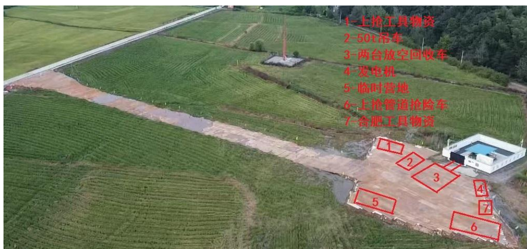
图 14.2-2 阀室放空回收作业现场车辆机具摆放位置图
