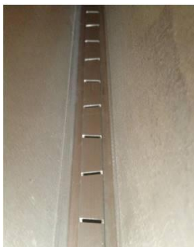
图 4.2-4 天线加工示意图
