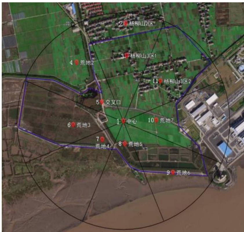
图 3-4 环境 \gamma 辐射空气吸收剂量率监测布点示意图
