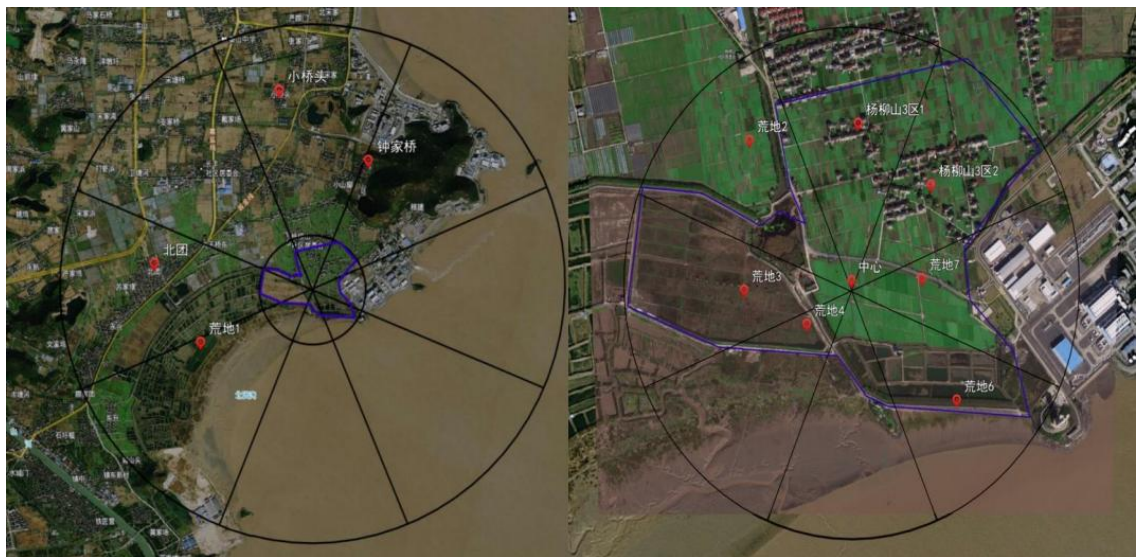
图 3-6 土壤样品环境 \gamma 辐射空气吸收剂量率取样布点示意图
