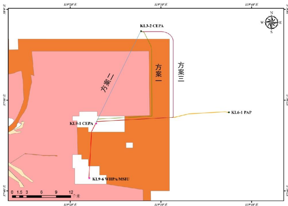
图 3.3-2 KL9-1CEPA 至 KL3-2CEPA 输油管道路由比选
