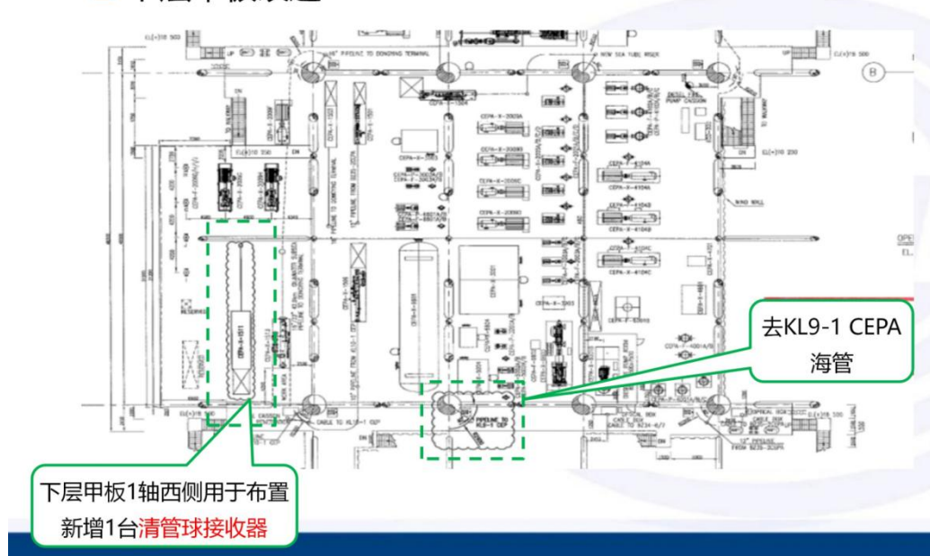
图 3.5-1 KL3-2CEPA 中心平台中层和下层甲板改造
