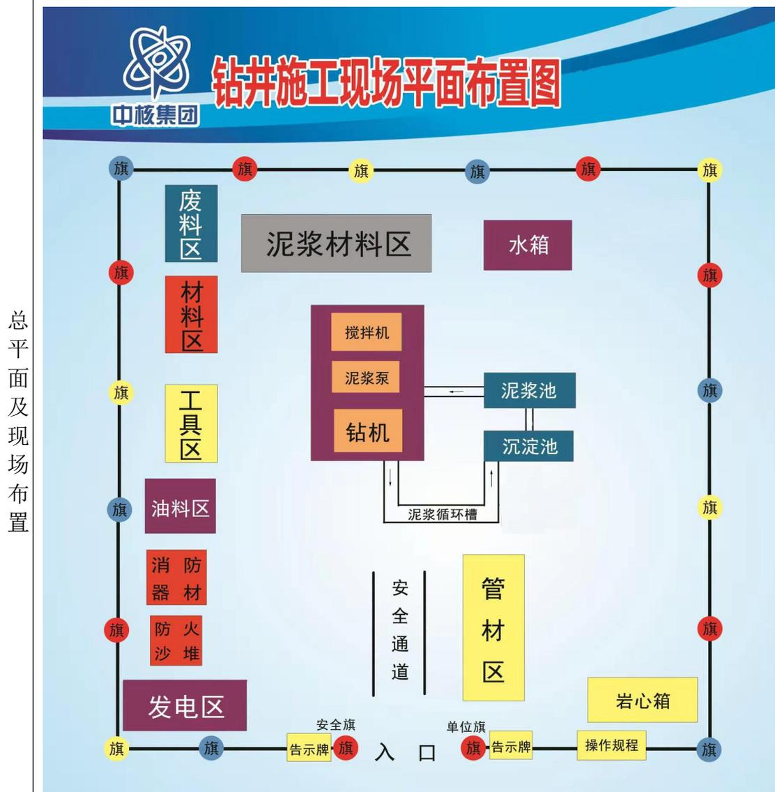
图 2-4 钻井机台场地布置示意图
