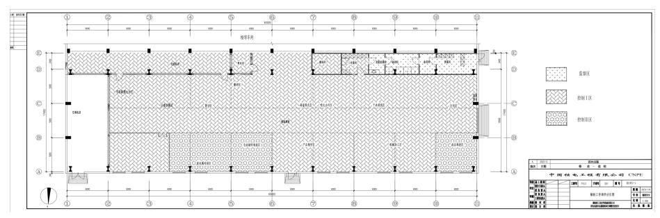
图 3.4 核电站废旧金属循环再利用加工厂房辐射防护分区图
