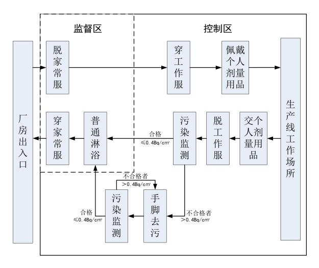
图 3.5 卫生出入口流线关系图
