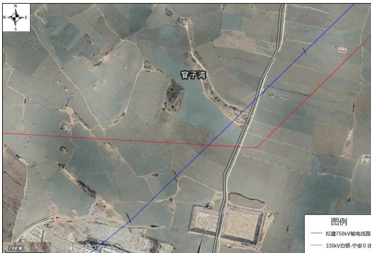
图 3.1-16 输电线路与 330kV 白银-宁安 II 线交叉跨越情况示意图
