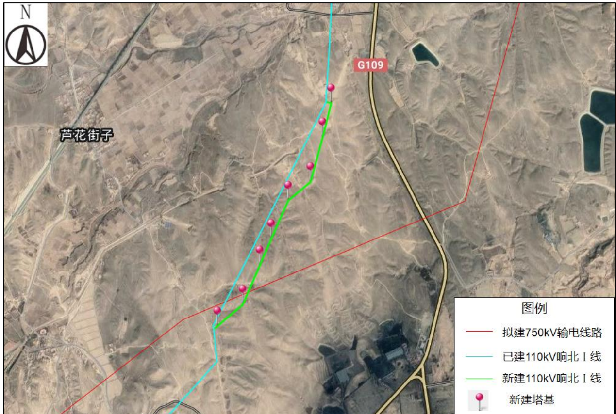
图 3.1-19 110kV 响北I线临时过渡改造示意图
