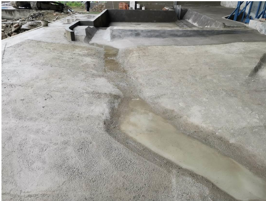
图 7.2-22 试验模型（比尺：1:30）
