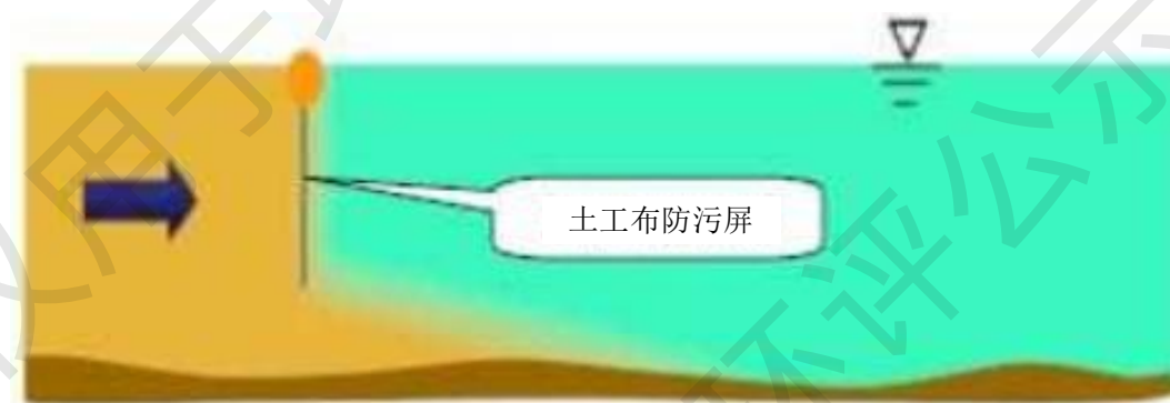
图 10.1-5 土工布防污屏防污机理示意图
