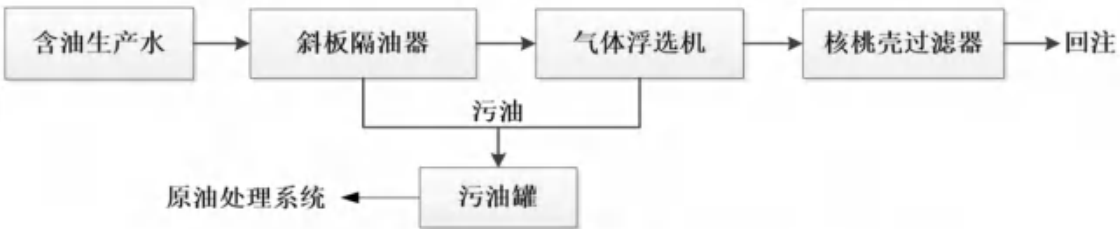
图 2-2 QHD32-6CEPI 平台生产水处理系统工艺流程示意图
