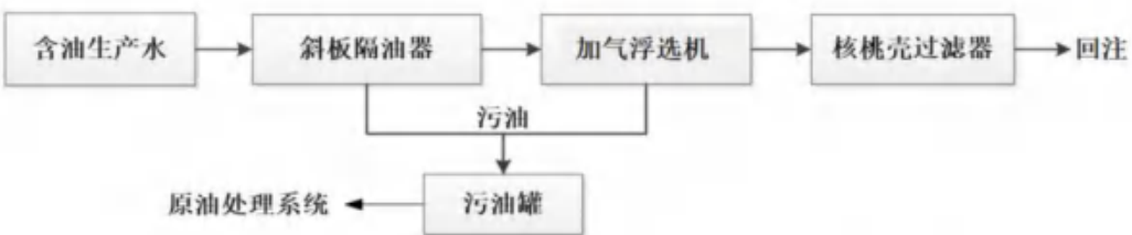
图 2-3 QHD32-6FPSO 生产水处理系统工艺流程示意图
