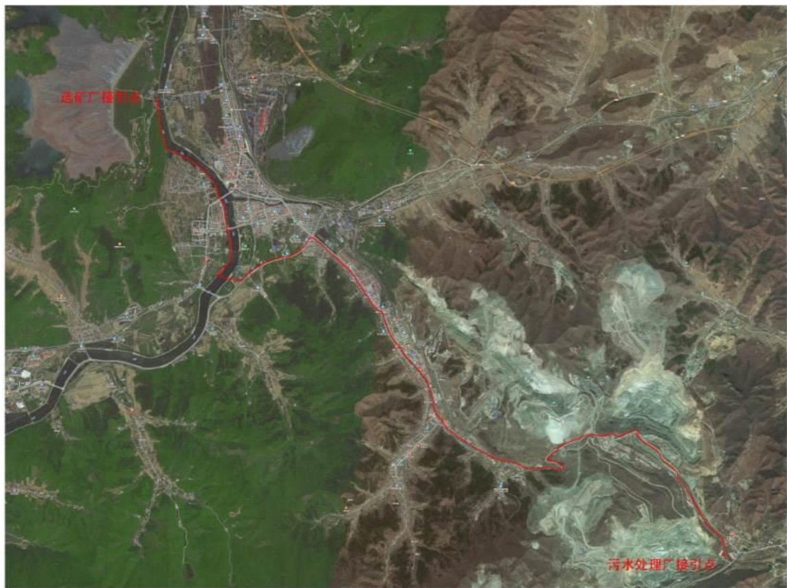
图 3.3-2 吸附尾液回用管线布置示意图
