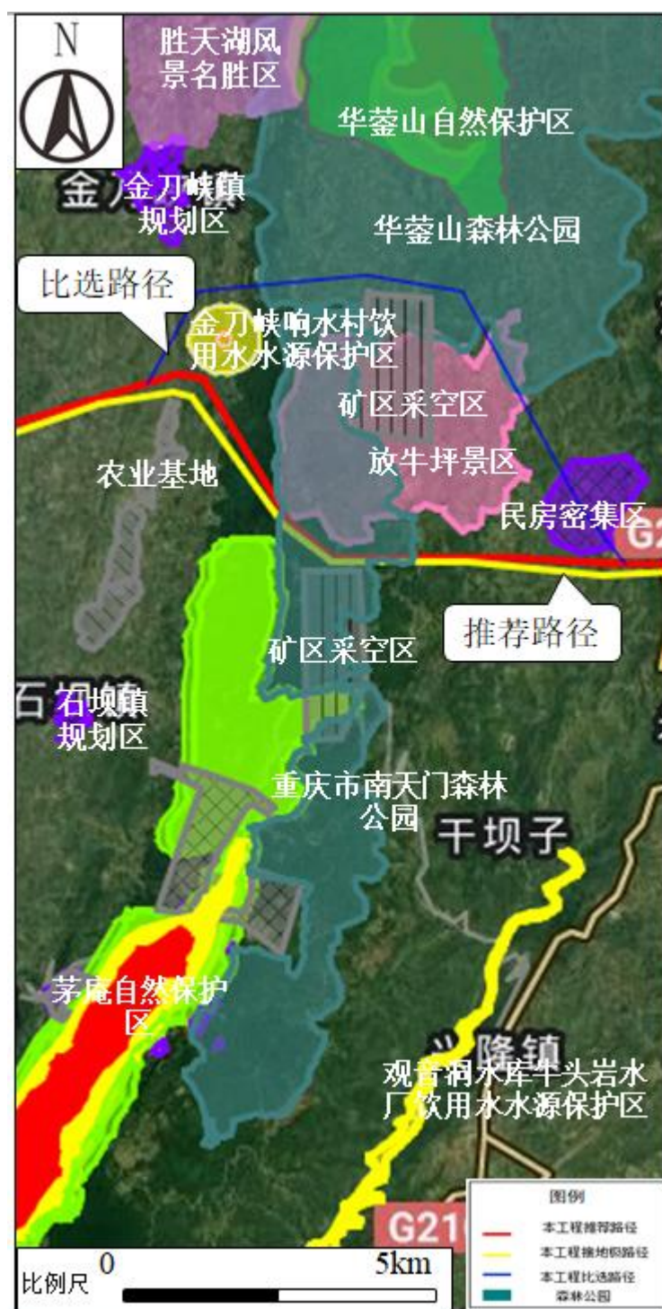
图 3.5-42 直流输电线路、接地极线路穿越重庆市南天门森林公园段障碍物信息及路径比选图
