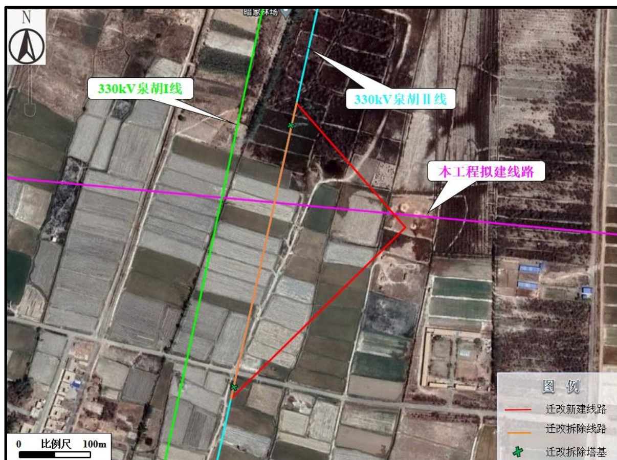
图 3.1-4 330kV 泉胡 II 线迁改路径示意图
