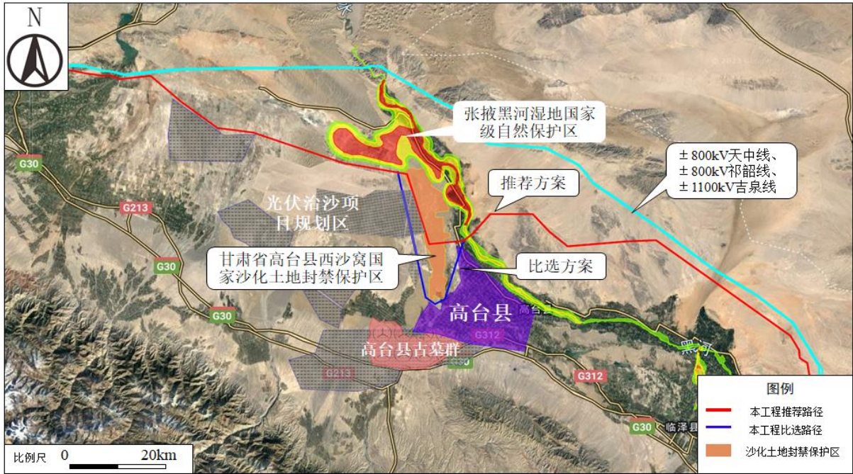
图 3.5-16 直流输电线路穿越甘肃省高台县西沙窝国家沙化土地封禁保护区段障碍物信息及方案比选图
