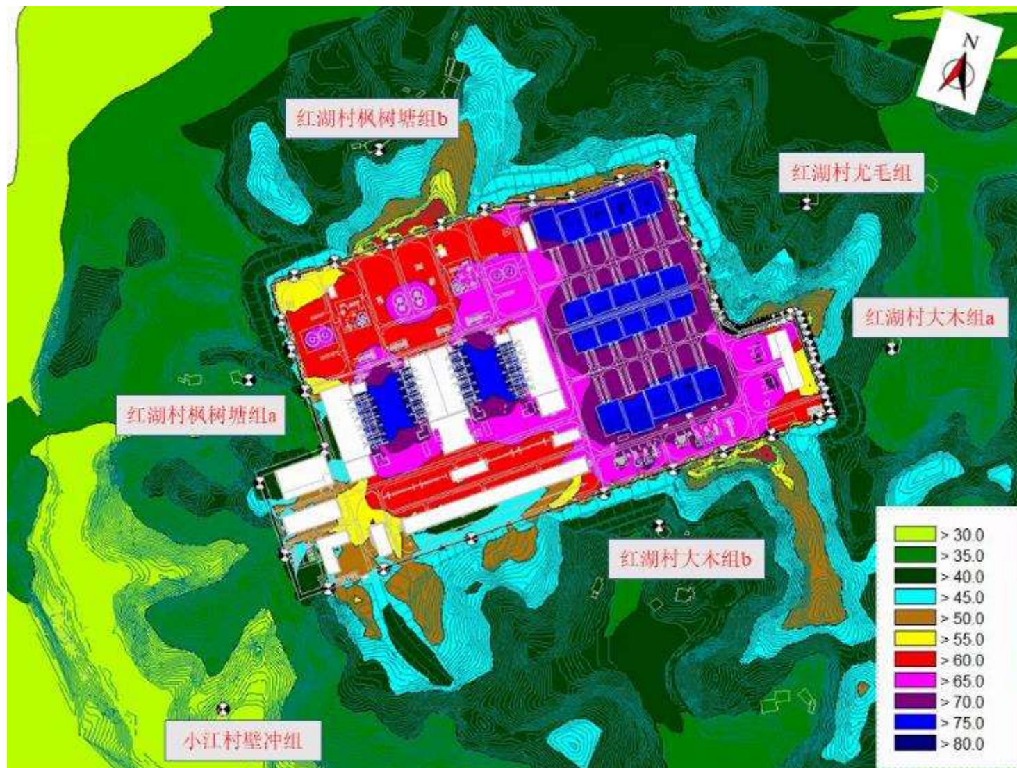
图 6-21 湖南换流站本期噪声贡献值等声级曲线预测图（1.2m 高）
