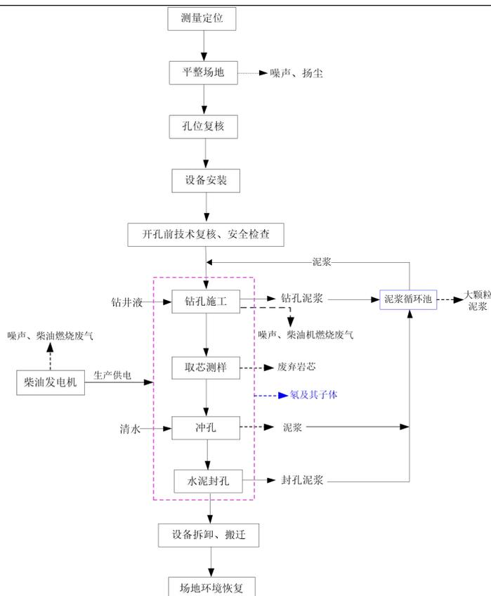
图 6-3 项目地质孔钻探排污节点
