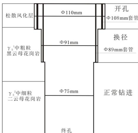
图 6-1 钻孔结构设计图 ( $\Phi 110\text{mm}$ )
