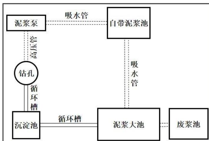
图 6-4 钻井过程中泥浆循环图
