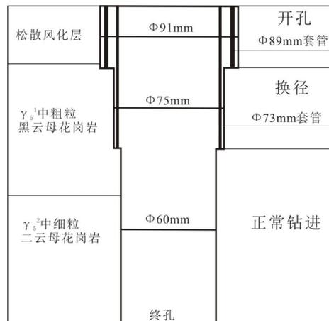
图 6-2 钻孔结构设计图 ( $\Phi 91\text{mm}$ )
