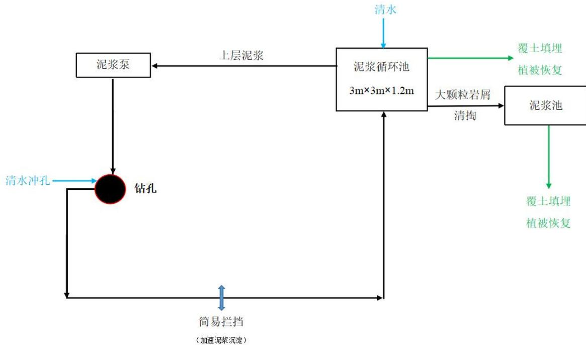
图 6-2 钻孔泥浆循环过程图
