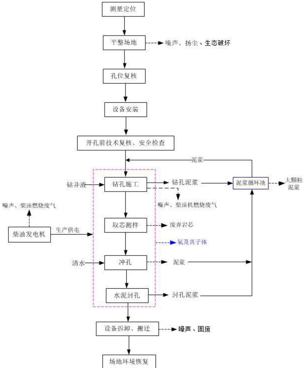
图 6-1 工艺流程及产污环节图
