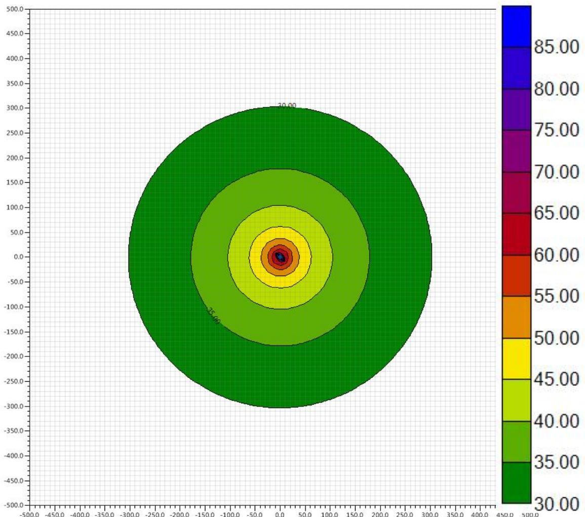
图 8-1 钻孔噪声贡献值等值线图
