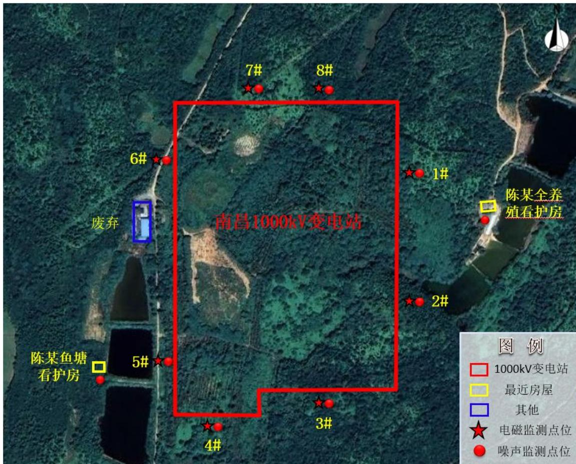
图 4-2 南昌变电站监测布点示意图
