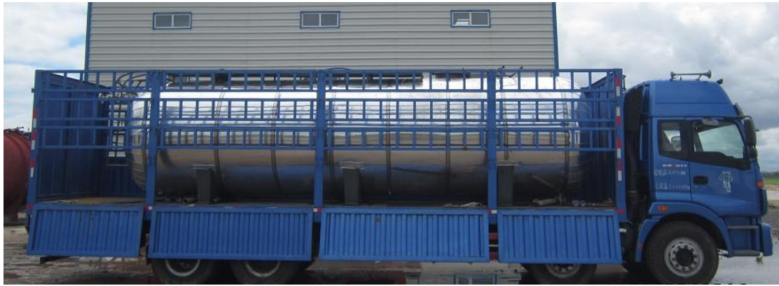
图 6-2 地浸采铀试验项目树脂转运车
