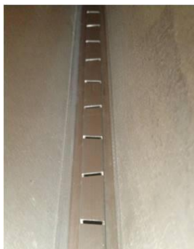
图 4.2-4 波导缝隙阵列天线局部俯视图 图 4.2-5 天线加工实物图
