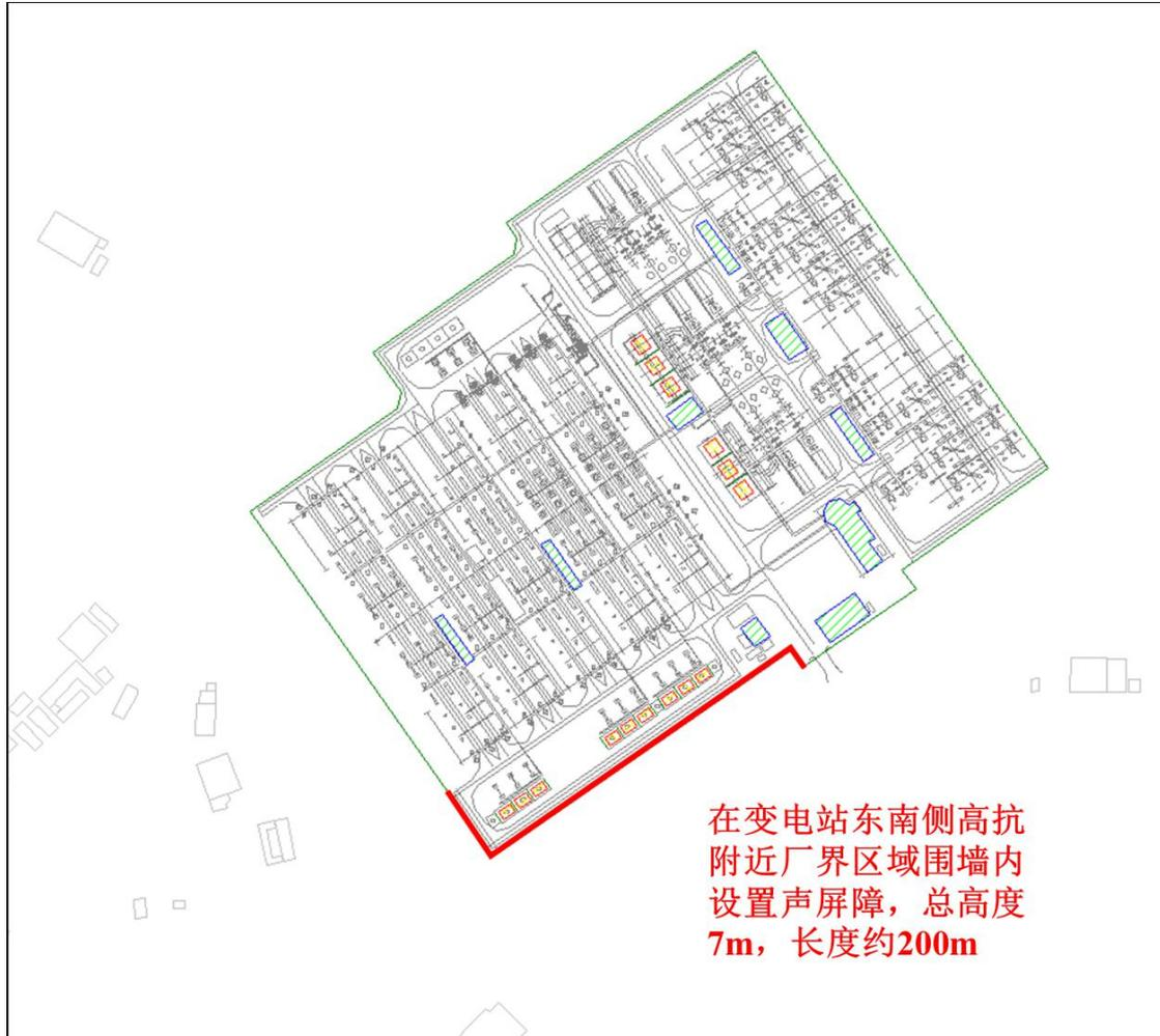
图 3.4 嘉应 500kV 变电站噪声治理措施布局示意图
