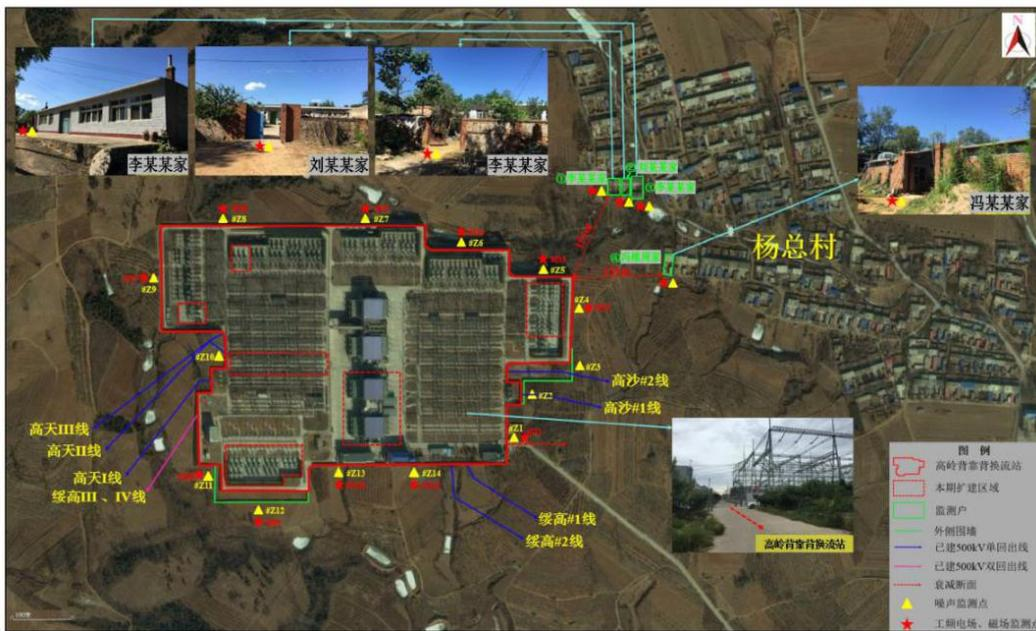
图 6.1(b) 高岭换流站交流电磁环境监测布点图
