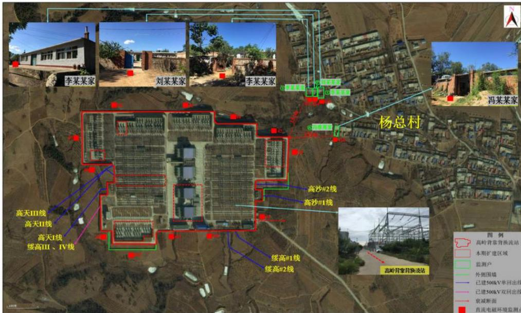
图 6.1(a) 高岭换流站直流电磁环境监测布点图
