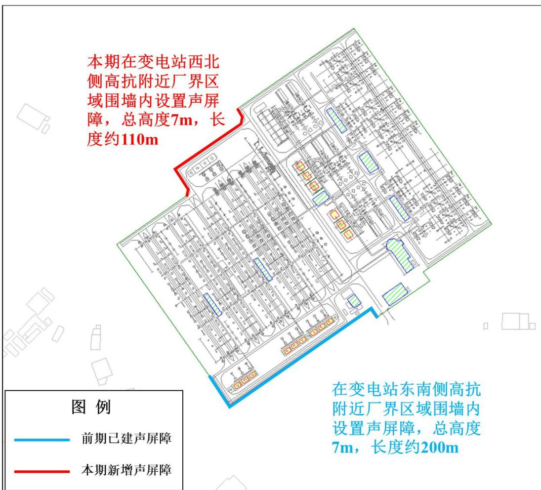
图 6.17 嘉应 500kV 变电站本期新增噪声治理措施示意图
