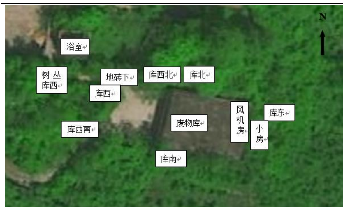
图 8-7 放废库周边土样取样点示意图
