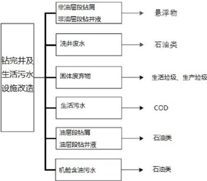
图 2.3-1 本工程施工期排污节点图
