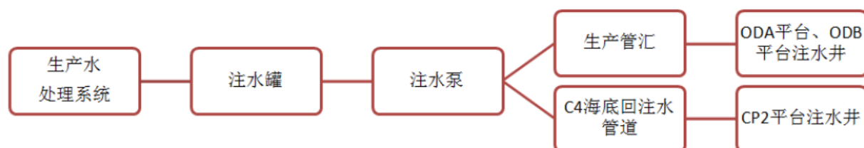
图 2.2-7 注水过程流程图
