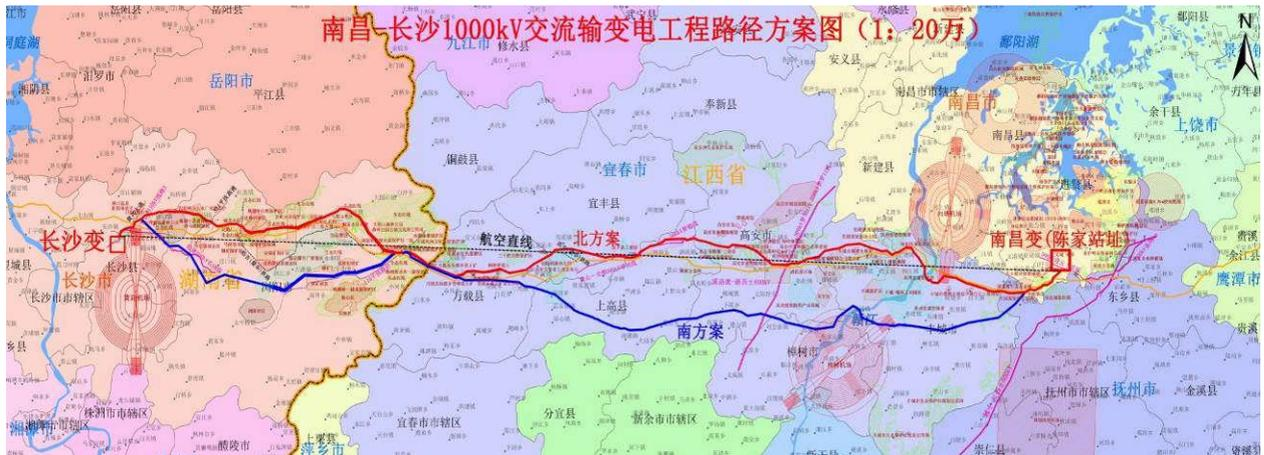
图 3-1 南昌~长沙输电线路比选路径示意图
