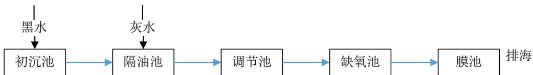
图 2.1-7 绥中 36-1 油田 WHPG 和 WHPH 平台生活污水处理流程
