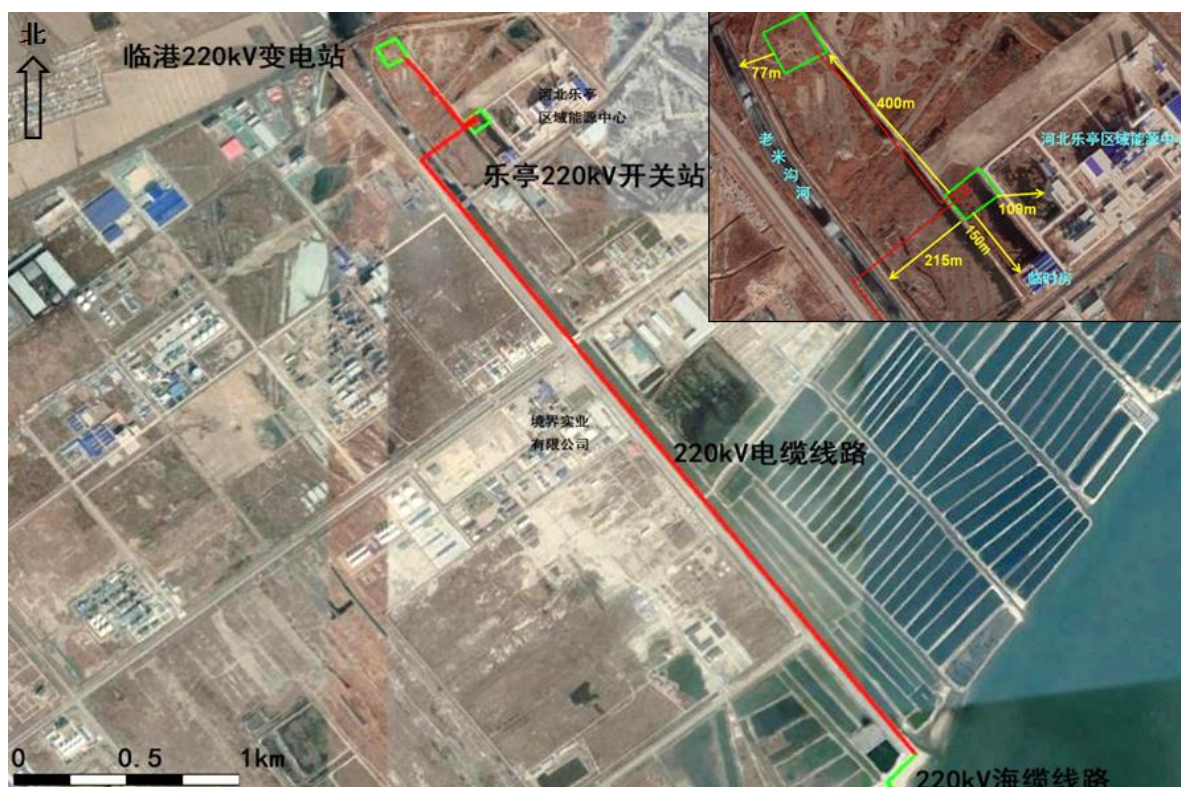
图 2.1-17 开关站位置及电缆线路路径图
