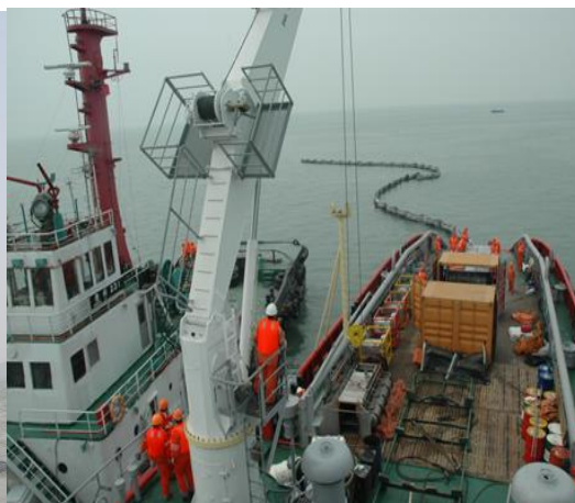
图 8.6-9 海洋船舶中心溢油回收图
