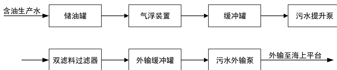
图 11.1-8 海三联含油生产水处理流程图
