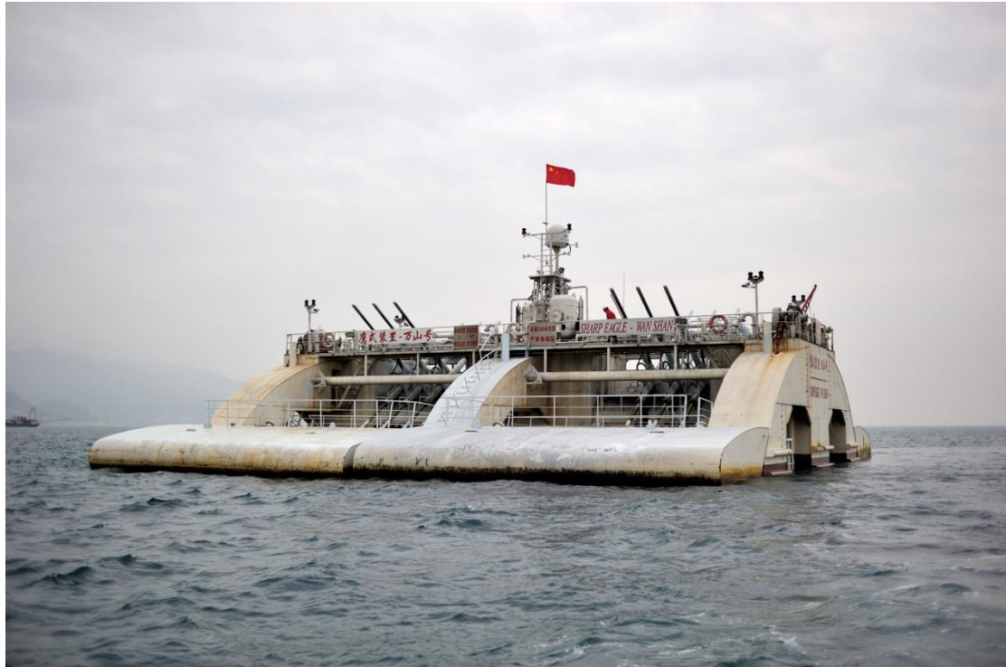
图 2.4-5 本项目波浪能发电试验装置
