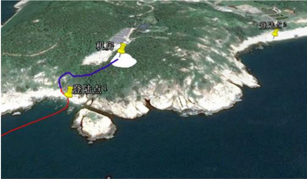
图 2.4-12 海底电缆登陆点及与机房位置关系示意图
