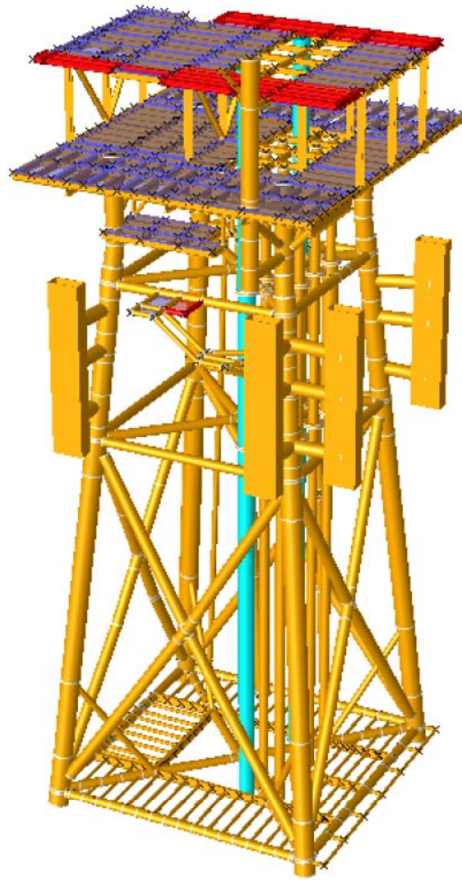
图 2.2-29 曹妃甸 11-6 油田 WHPF 平台内挂井槽结构模型图
