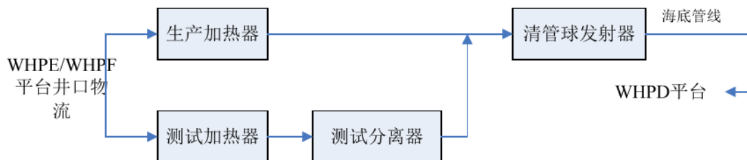
图 2.2-6 曹妃甸 12-1/12-1S 油田 WHPE、WHPF 生产集输工艺流程图
