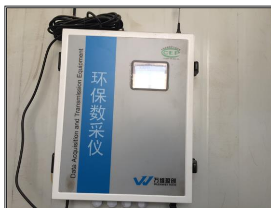
锅炉尾气数采设备
