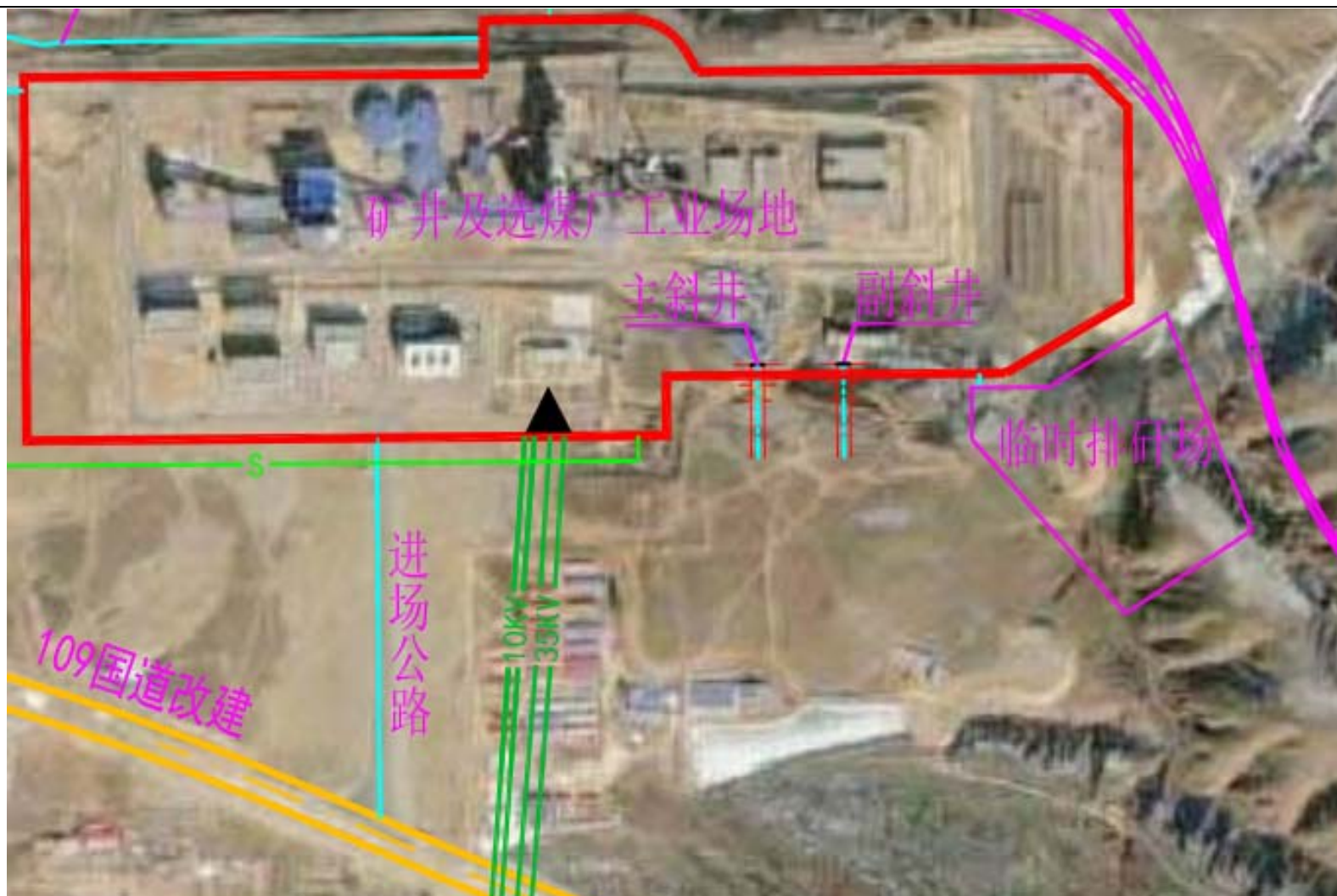
图 3.5-1 变更环评阶段临时排矸场位置示意图
