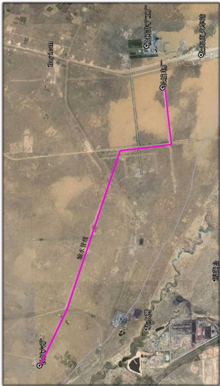
图 3-4-3 矿井至长城电厂输水管线走向
