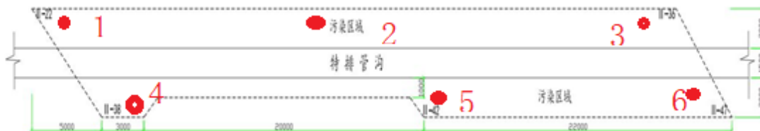
图 3.2-12 114 热工实验室北侧管沟污染区域
