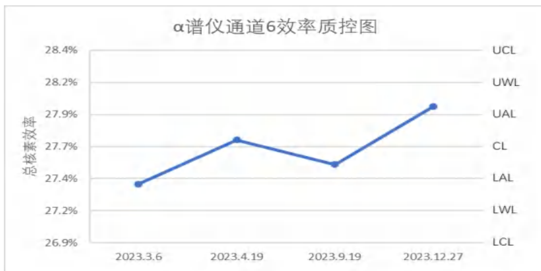
图 3.1-25 \alpha 谱仪通道 6 效率质控图 (2023.3~2023.12)
