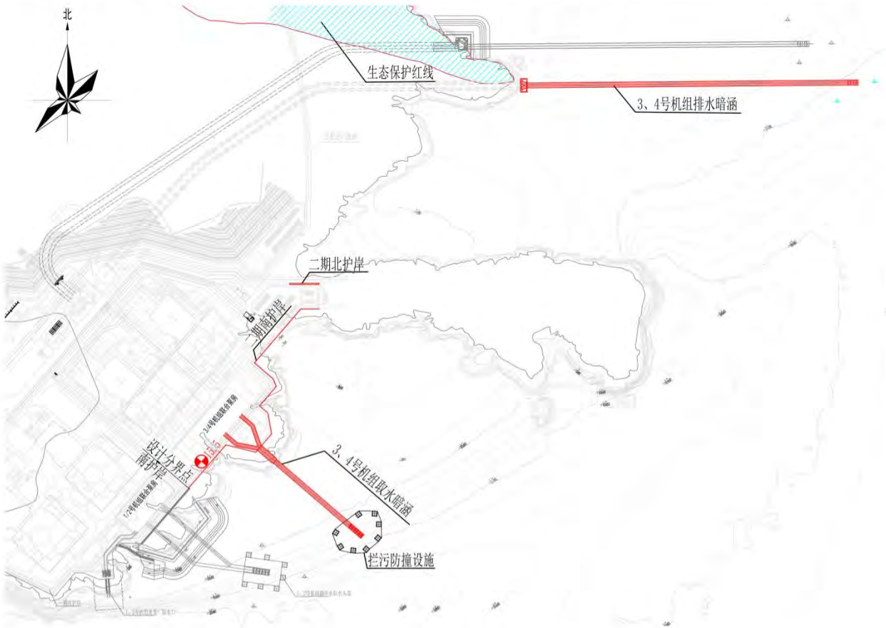
图 4.3-1 金七门核电工程 3、4 号机组取排水方案总平面布置图
