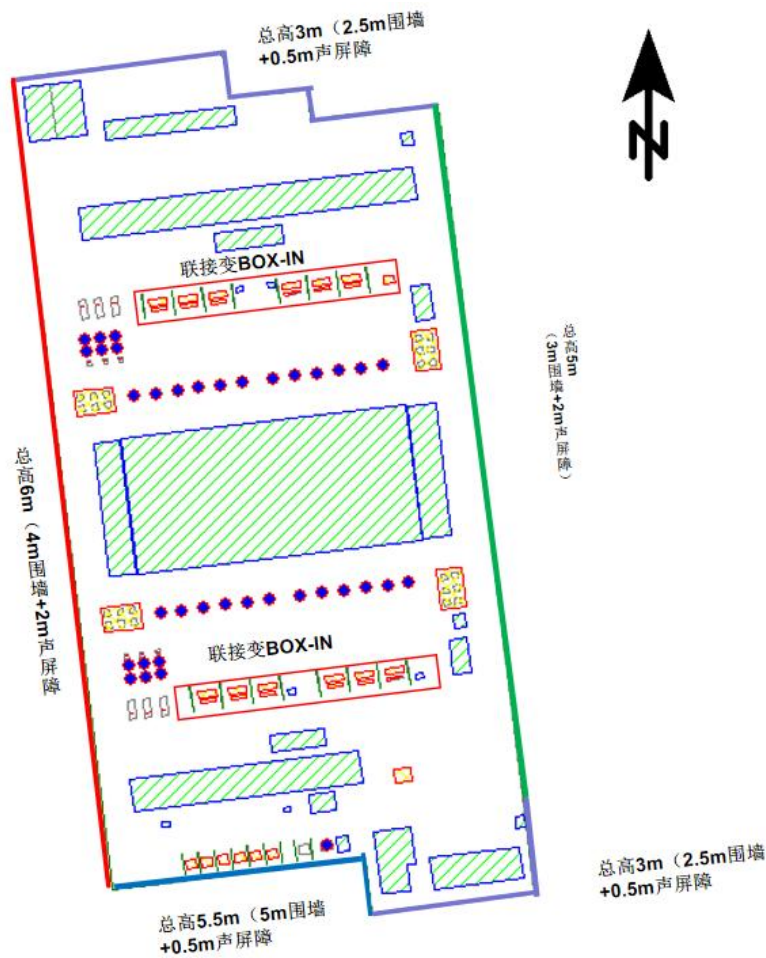
图 6.2-3 换流站预测模型三维示意图
