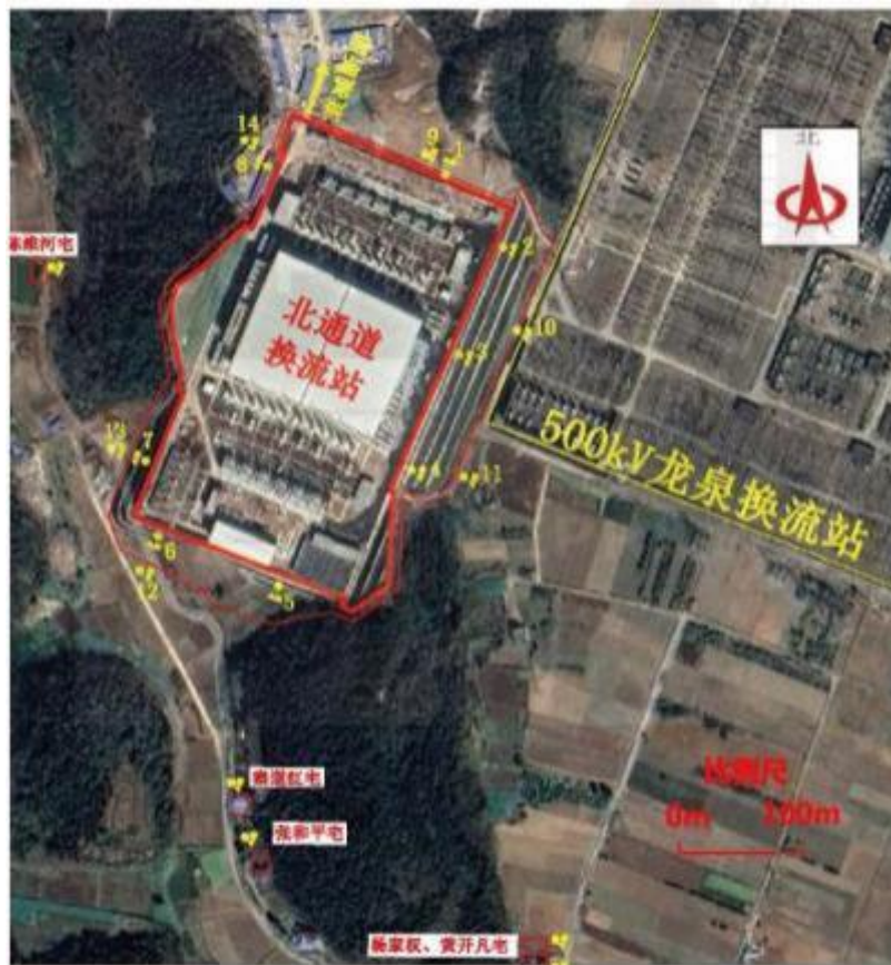
图 6.1-1 宜昌换流站厂界及断面监测布点图
