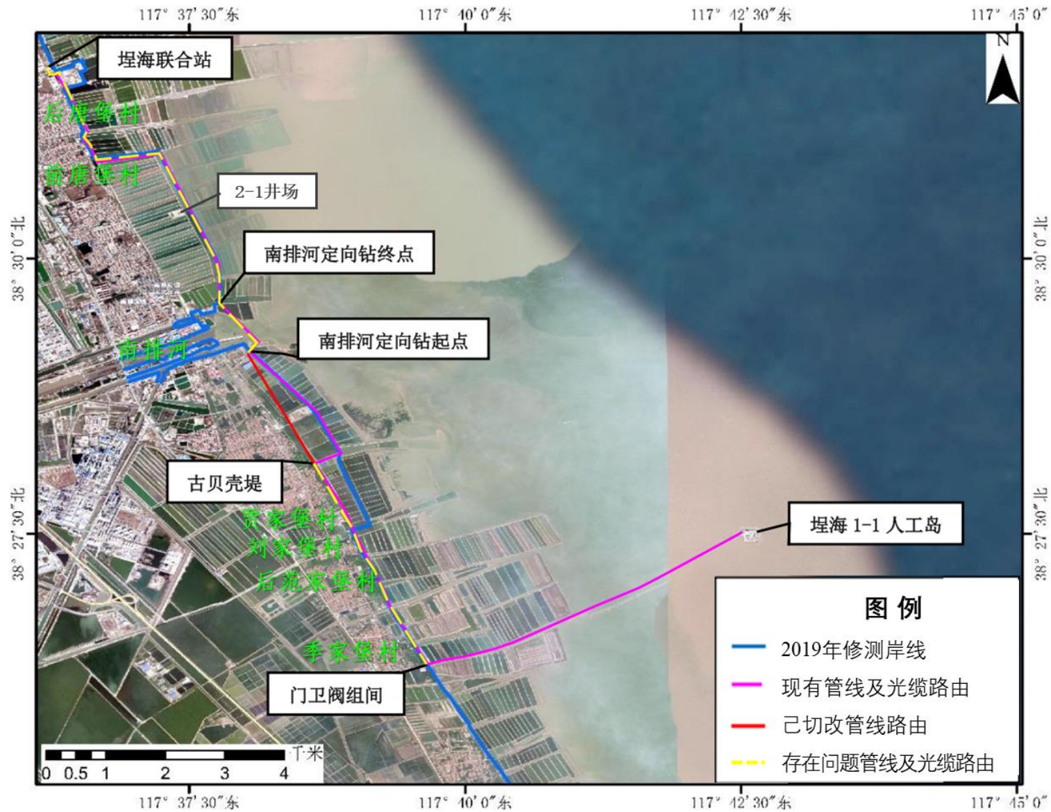
图 2.1-2 现有工程输油管线、光缆路由及存在问题路由示意图
