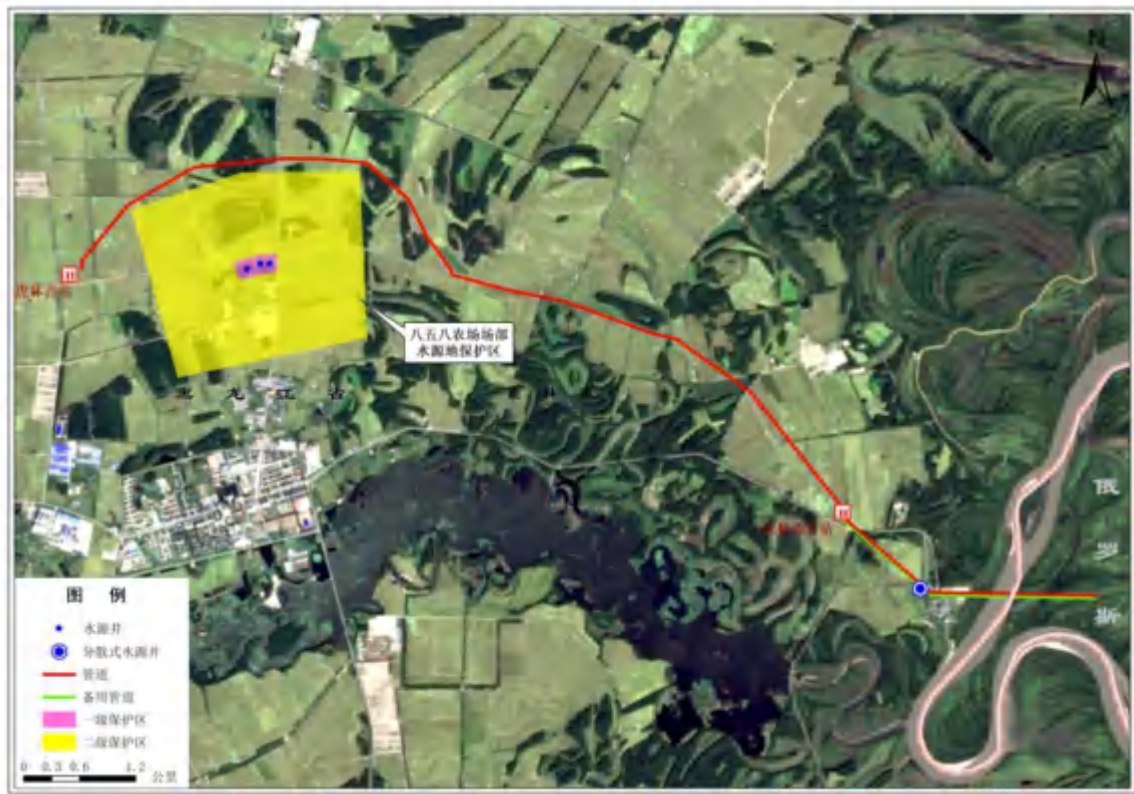
图 1.8-5 管道与地下水环境保护目标位置关系示意图
