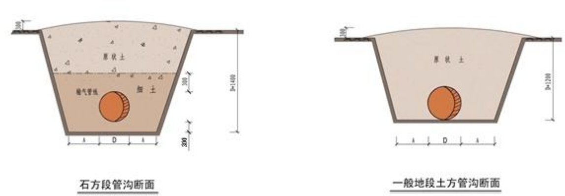
图 2.6-1 不同地段管沟断面示意
