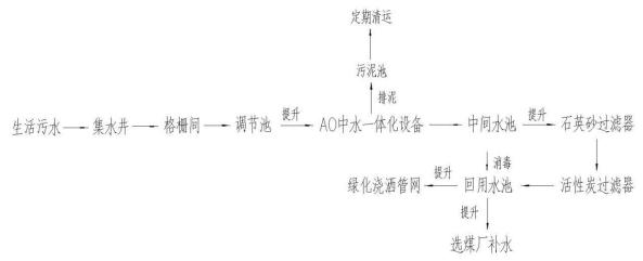
图 7.4-1 生活污水处理工艺流程图
