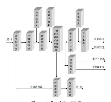
图 7.4-2 矿井水处理工艺流程
