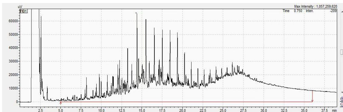
图 55 储油罐底油泥渣的色谱图（709 罐）
