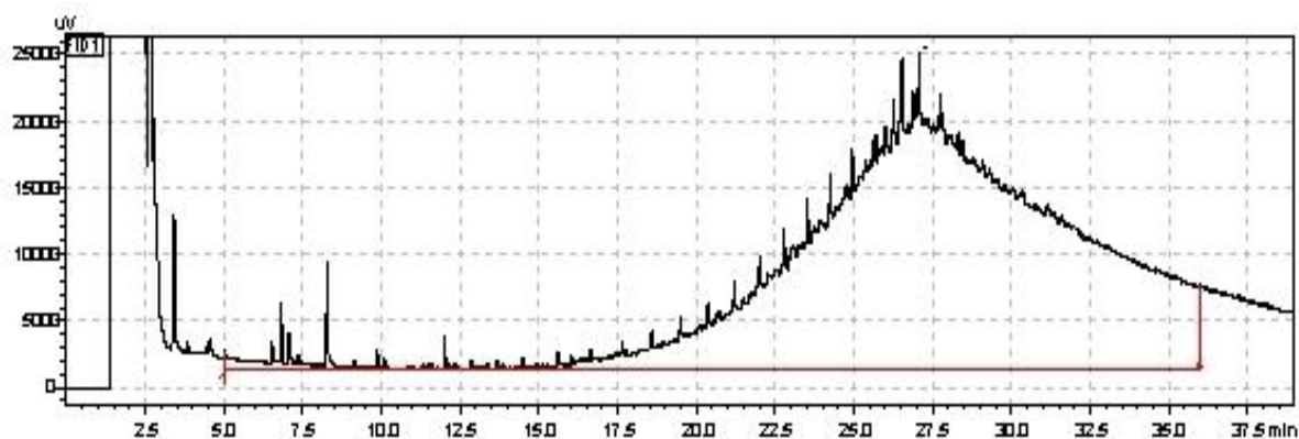
图 57 防水卷材样品中石油烃（C 10 -C 40 ）的色谱图
