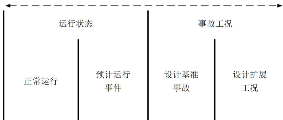
图 3 没有场外应急设施的状态
