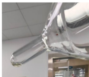
图 24 液液萃取液浓缩至近干 ( \rho=5.0 \mu\text{g/mL} )
